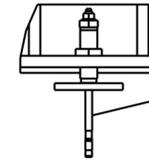
Per fissare il BASAMENTO MACCHINA utilizzare TASSELLI IN ACCIAIO X CALCESTRUZZO FISCHER art.45267 FBN II 12/120 (12X216) o similare con boccola di espansione dado e rosetta NON DI NOSTRA FORNITURA
